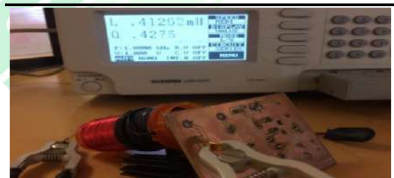
Figura 3.6. Inductancia de la bobina secundaria.
