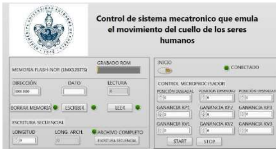
Figura 3. Interfaz gráfica de control, la cual se encarga de programar el micro controlador, enviar los parámetros deseados y adquirir los datos calculados.
