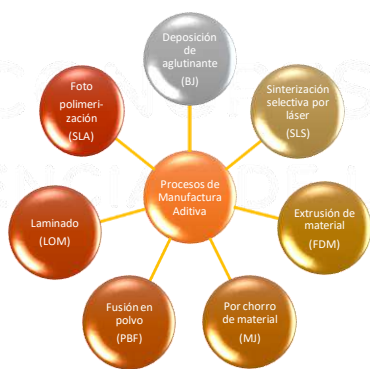
Figura 1. Clasificación de procesos de manufactura aditiva según la norma ISO/ASTM 529000:2015 [8].
